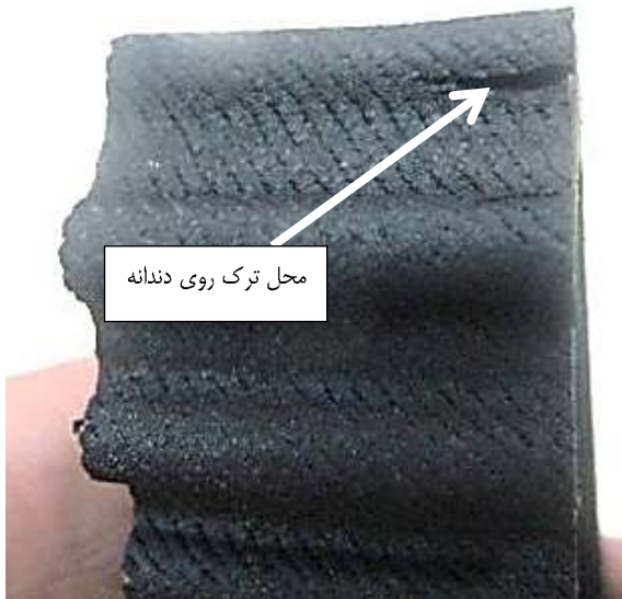
شکل ۲: ترک روی دندان تسمه زمانبندی
