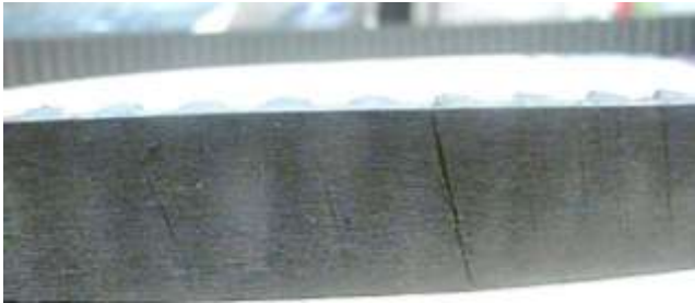
شکل ۳: ترک در پشت تسمه زمانبندی
