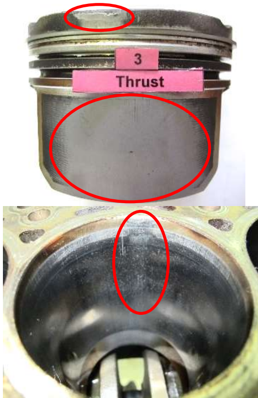
شکل ۵: علائم عیب سایش در استوانه و سمبه شماره ۳
