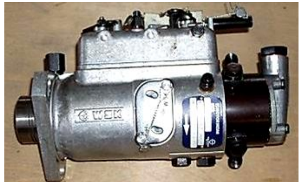
شکل ۱: تلمبه افشانه دوار WSK-DPA
