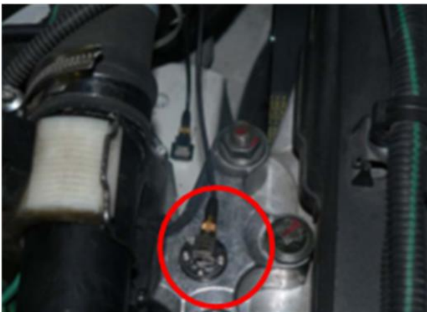
شکل ۵: نمایی از محل نصب شتاب‌سنج‌ها برای اندازه‌گیری شتاب موتور ملی در محل اتصال به نگهدارنده‌های آن شامل (الف) نگهدارنده روی جعبه دنده، (ب) نگهدارنده گشتاوری و (ج) نگهدارنده هیدرولیکی
