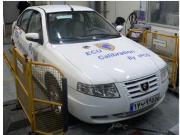
شکل ۴: نمایی از آزمون به کمک لگام ترمز غلتکی بر روی خودروی سمند مجهز به موتور ملی
