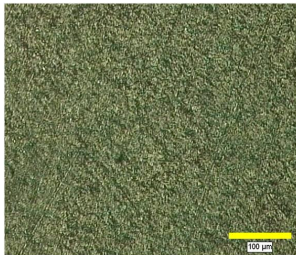
شکل ۲: ریز ساختار فنر دریاچه شکسته
