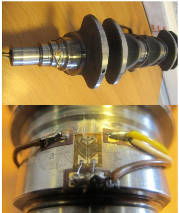
شکل ۶: کرنش‌سنج‌های نصب شده بر روی میل‌لنگ
