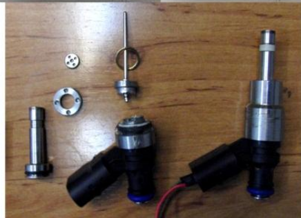
شکل ۲: نمای از افشانه با قطعات جدا شده از یکدیگر
