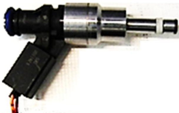
شکل ۱: افشانه تک سوراخ بوش
