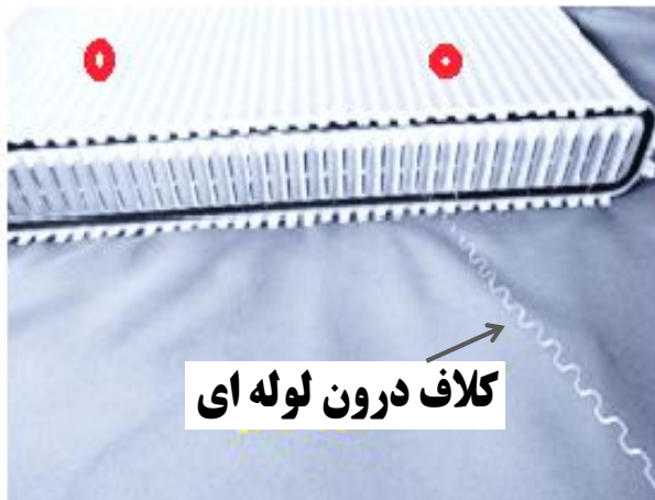
شکل ۳: کلاف درون لوله‌ای آزمون‌ها
