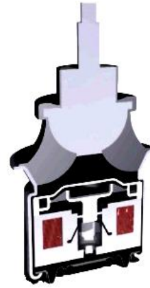
شکل ۲: نمای مقطع جانبی دسته‌موتور پیشنهادی در نرم افزار کتیا
