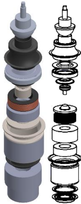
شکل ۱۱: اجزای دسته موتور چند محفظه ای نوین با قابلیت خنک کاری
