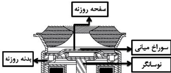
شکل ۸: ریز اجزای بخش میانی دسته موتور توسعه یافته چندمحفظه ای با قابلیت خنک کاری
