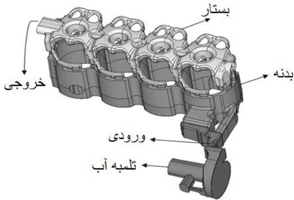
شکل ۷: هندسه سه بعدی راهگاه آب موتور پرخوران
