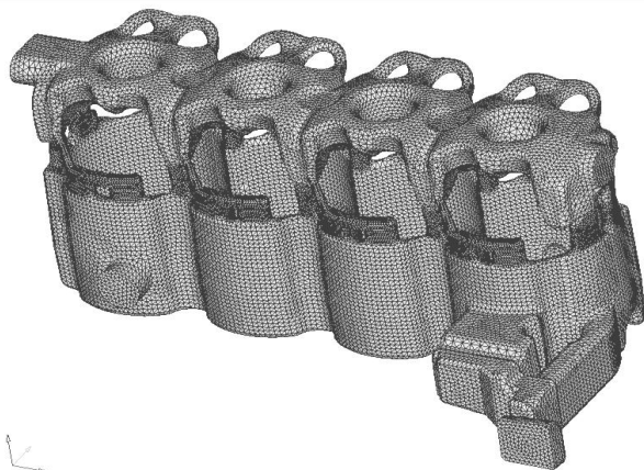
شکل ۸: شبکه بندی راهگاه آب موتور ملی پرخوران
