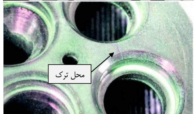
شکل ۱۱: بستار ترک خورده در موتور دیزل [۱۷،۲۶]
