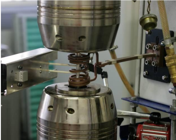
شکل ۲: تجهیزات آزمون خستگی کم بسامد
