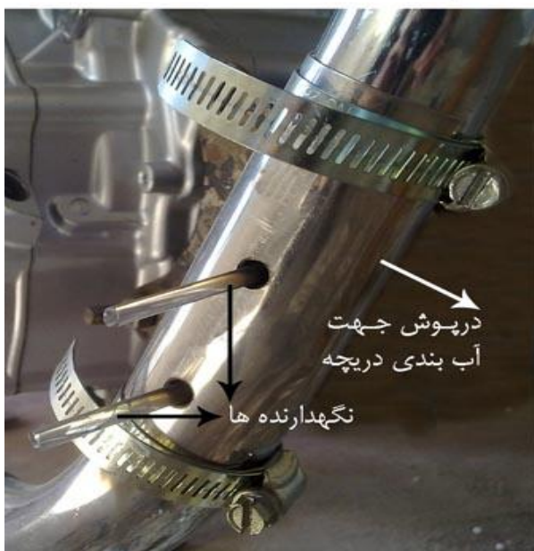
شکل ۱: نحوه قرار گرفتن نمونه‌ها خروجی موتور (گازهای خروجی)
