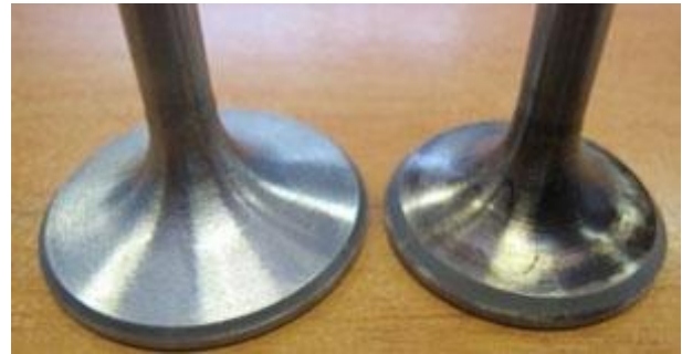
شکل ۴: عیب لقی غیر مجاز در دریچه‌های سالم استوانه ۴
