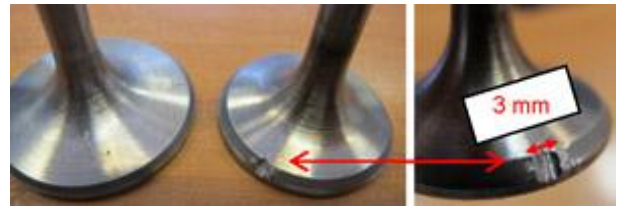
شکل ۳: عیب لب پریدگی دریچه دود در استوانه ۳
