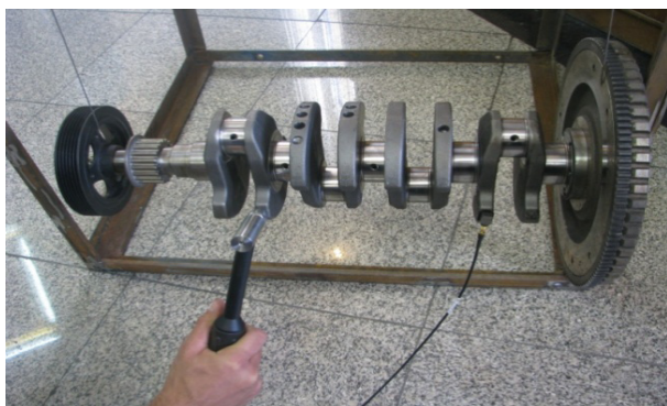
شکل ۶ اندازه‌گیری شتاب نقطه ۲ با تحریک نقطه ۷
