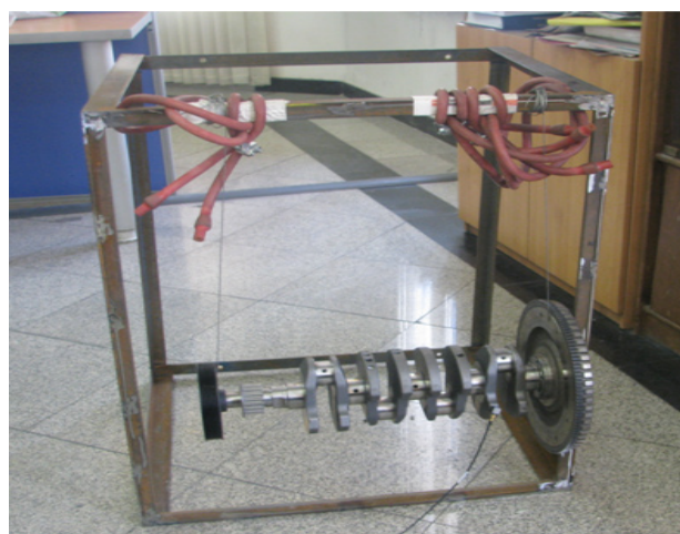
شکل ۵ نحوه آویزان کردن سامانه از سازه
