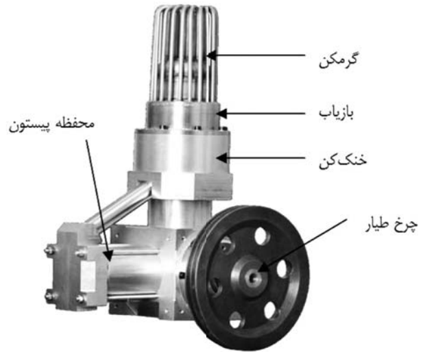
شکل ۲ ب - موتور ST500 از نوع کامله دارای توان خروجی 500w، حجم کمینه 1.37e-3m^3 ، حجم بیشینه 1.79e-3m^3 و فشار کاری 9bar
