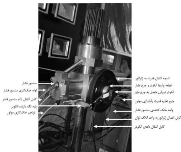
شکل ۱۴ موتور ST500 و تجهیزات داده برداری
