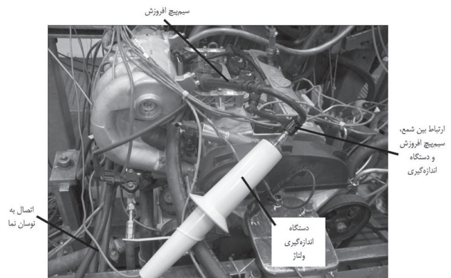
شکل ۵ اندازه‌گیری ولتاژ مورد نیاز جرّقه در اتاق آزمون
