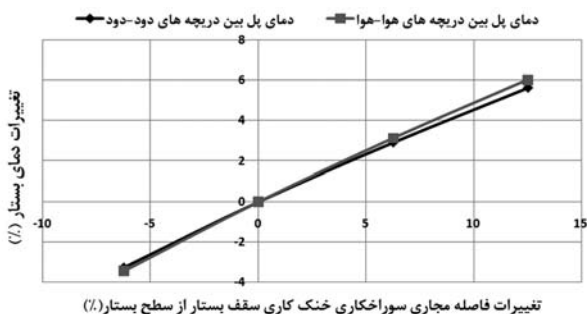
شکل ۲۲ اثر فاصله مجاری سوراخ کاری خنک کاری سقف بستر تا سطح شعله بستر بر دمای پل بین دریچه‌های دود-دود و هوا-هوا
