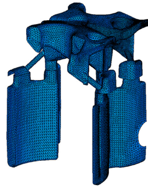
شکل ۷ نقشه شبکه‌بندی شده راهگاه مایع خنک‌کاری
